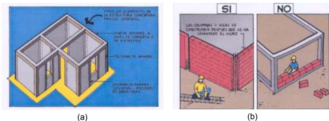
Fig. 5-26 Extract from “Manual de Construcción, Evaluación y Rehabilitación sismo resistente de viviendas de mampostería”: (a) Distribution of column and beam confinement elements (p. 1-30); (b) Construction procedure of confinement elements (p. 1-30).
