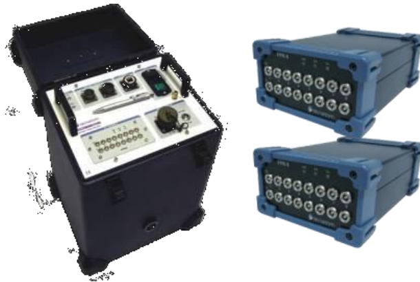
Fig. 5 – SUMIAD F1 UT DAS & 2 FR8 modules
