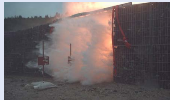
Abbildung 20: Ringflecht mit Wasserelement in einem Explosionstest (Bild von UniBwM, WTD52)
