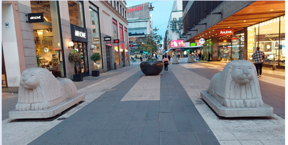
Abbildung 6: Betonlöwen und Blumentöpfe, die verwendet werden, um einen direkten, geradlinigen Zufahrtsweg im Falle eines Angriffs zu vermeiden (Bild von Martin Larcher).
