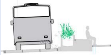
Abbildung 8: Eine runde, kombinierte Pflanz-/Sitzbank ist um den öffentlichen Raum herum angeordnet und dient als Rammschutz für Fahrzeuge (Bild von Brussels Mobility)
