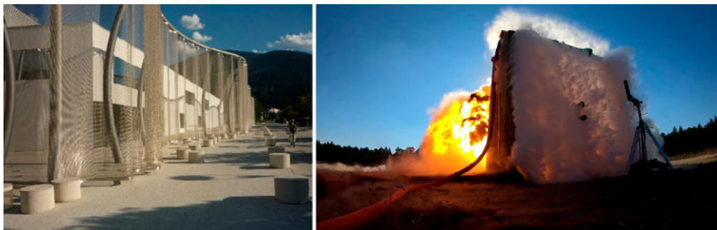
Abbildung 63: Ringgeflecht und Poller (links) (Foto: Norbert Gebbeken) und Ringgeflecht mit Wasserspiel während eines Explosionstests (rechts) (Foto: BAM-UniBwM)
