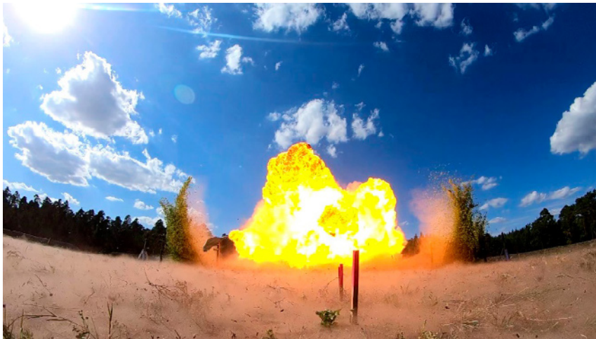
Abbildung 62: Berberitzenbäume bei einem Explosionstest (Bild: BAM-UniBwM)
