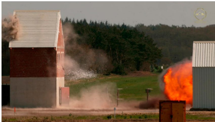
Abbildung 57: Glasscherben werden durch die Sogphase der Explosionswelle in den öffentlichen Raum geschleudert (Foto: UniBwM, WTD52)
